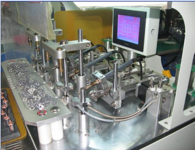
Machine de soudage par points automatique
